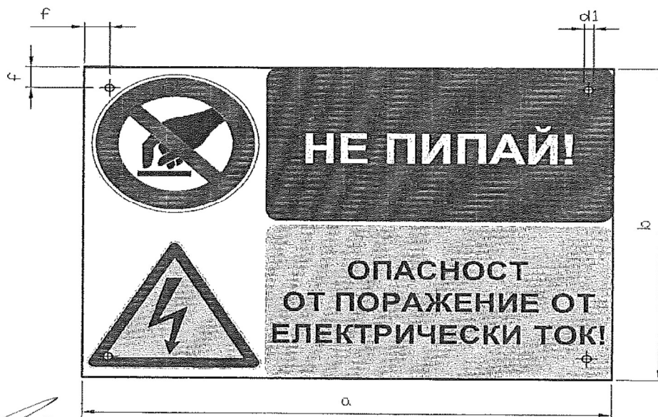
Фиг. 2 Табела „Не пипай! Опасност от поражение от електрически ток!“
